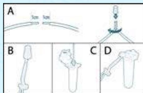
Une fois la boucle terminée, dénudez les deux extrémités du fil et insérez-les dans la prise de connexion du fil d'antenne située sur le boîtier émetteur.
