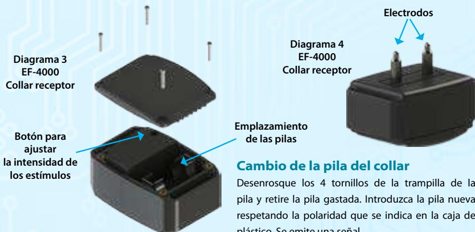
sonora que indica que el collar está encendido. Si por descuido invierte la pila respecto a las polaridades indicadas, el collar deja de emitir señales sonoras. Debe colocar la pila rápidamente.
