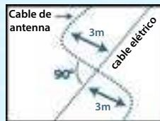
Si necesita más de 150 m de cable de antena, deberá conectar las diferentes longitudes de cable con los conectores de enlace del cable de antena previstos para ello. Puede encargar a su distribuidor o DOGTEK, en cualquier momento, bobinas de cable y conectores de enlace suplementarios.
